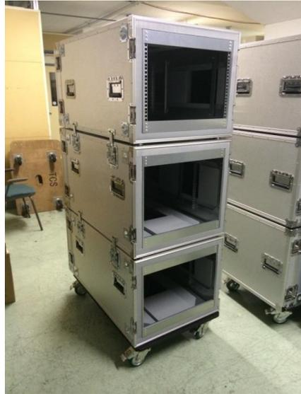
運送中の振動や衝撃吸収・緩和を考慮したトランクケース型のシステムラック。最外部をトランクケース、内部をシンプルなスチールラック型の二重構造にし、両者の中間を衝撃吸収クッションで埋め、キャスターもショックダンパー付を採用し、運送時のラックマウント機器への振動や衝撃を軽減する事が可能です。機器マウント部分のEIAアングル部分は四角穴のケージマウントタイプを採用しサーバータイプの実装もメーカー純正で対応できるように考慮しております。加えて上下左右に簡易連結が可能で複数のケースを仮固定し、設置場所でのシステム運用時のグループ固定も可能となっております。
