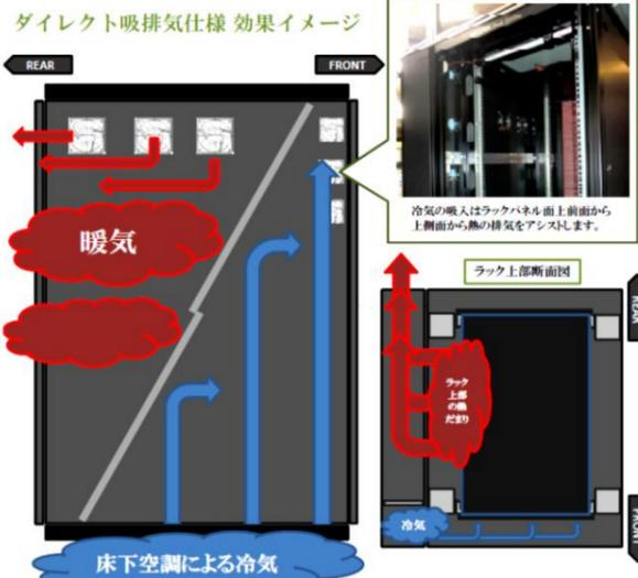
床下空調の冷気を、引き込まれにくい上部へダイレクトに送風し、留まりやすいラック上部の暖気を効果的に排出します。AR内部に遮蔽プレートを設置することにより、冷気と暖気の混合を防ぐことが可能。他にも3種のレイアウトパターンあり！
